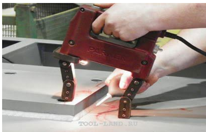
8 Сурет – Дәнекерленген жіктердің сапасын магнитті дефектоскопиямен тексеру
