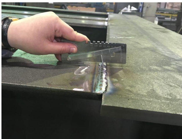
6 Сурет – Ақаудың геометриялық параметрлерін өлшеу
