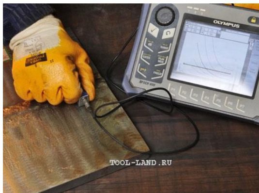
9 Сурет – Дәнекерлеу жіктерін ультрадыбыстық дефектоскопиямен тексеру
